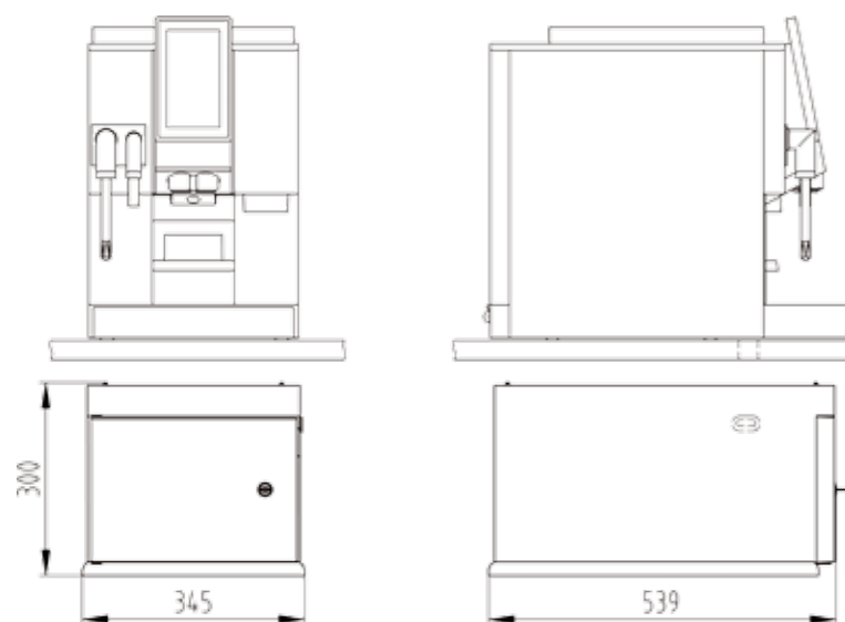
Unterstellkühlleinheit unter Kaffeemaschine
